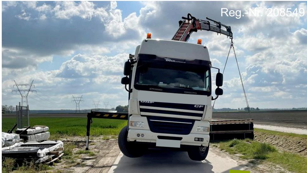
Aufgrund einer engen Baustraße und der dahinter wartenden Lkw setzte der Fahrer die linken Ausleger nicht ein und hob zwei Stahlpakete auf einmal an. Beim Anheben der Last schwenkte der Kran wegen Überlastung nach links und der Stahl fiel vom Lkw. Der Fahrer konnte der Ladung gerade noch ausweichen und stürzte in einen Graben.
